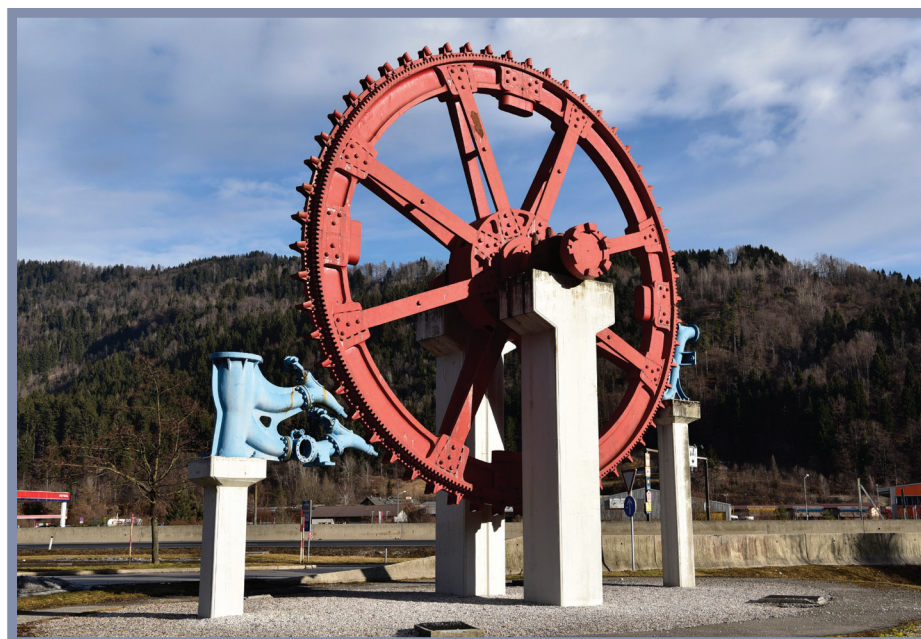
Največja Peltonova turbina v Evropi s premerom 9,16 metra (foto Silvo Kokalj)
